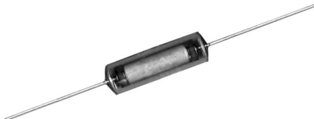
为实现最大程度的可靠性、稳定性和结构的一致性，Vishay Angstrom 密封型金属膜电阻无疑是首选。它采用真正的玻璃与金属密封外壳将电阻元件密封在惰性气体中，保护它免受所有不利环境影响。玻璃外壳能承受超过 3000 psi 的外部压力而不泄漏。Vishay Angstrom 密封型电阻用在几乎各类军事、导弹、航空和海洋学等要求最严格和环境最恶劣的应用，论证了它的可靠性和稳定性。
